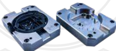
FH-FIX12 Nido para soldadura estación O30 Material aluminio
