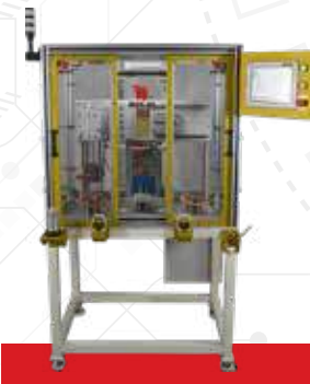
Estación de soldado por inducción de componentes 9F
