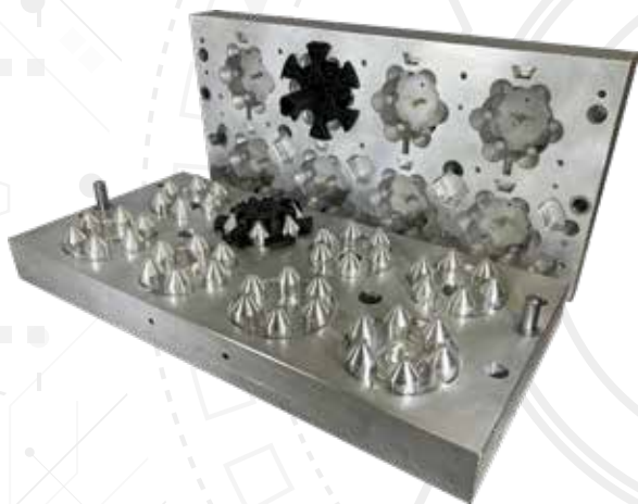
FH-MIP01 Cavidad molde aluminio gel
