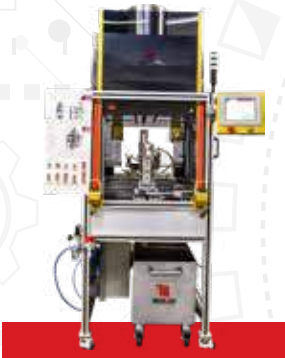
Estación de soldado por flamas de componentes 9F
