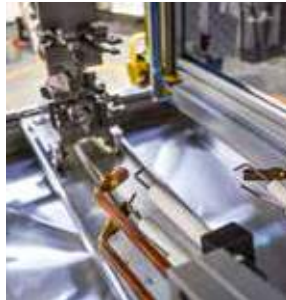
Estación de soldado por flamas de componentes 9F
